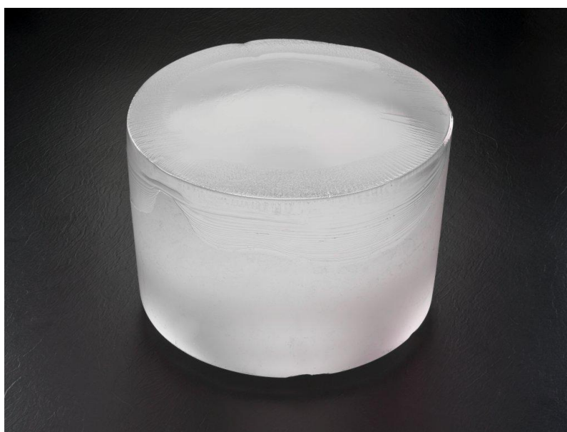
Obr. 14 Safír vzniklý metodou HEM [22]
